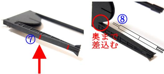
4. 次に部品⑨を細い方の柱の内側に差込み接着します。
